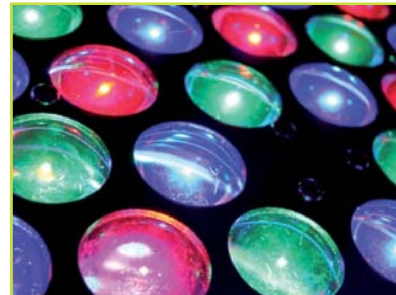
Vor jeder LED befindet sich eine kleine Glas-Linse
